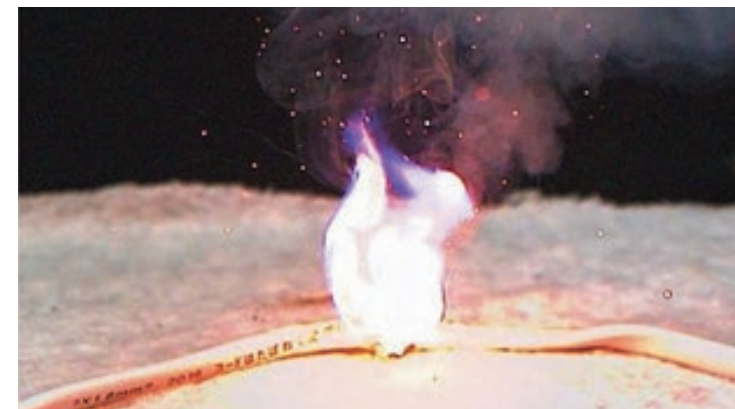
▲断線した電源コードの発火（写真提供：独立行政法人製品評価技術基盤機構）
