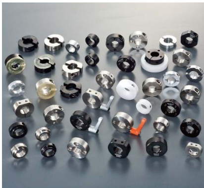
セットカラー。軸に取り付けてベアリングやプーリー等を固定する。
