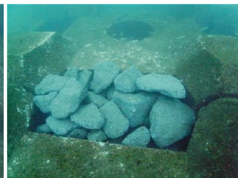
【人工砕石】 転炉系製鋼スラグと高炉スラグ微粉末等を練り混ぜて製造
