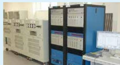
太陽光発電模擬装置、デジタルシミュレーター
