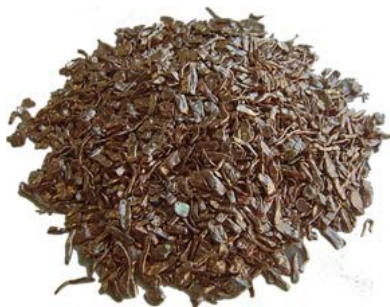
銅ナゲット (電線を破碎し被覆樹脂を剥離したもの)
