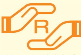
※対象物質（鉛及びその化合物、水銀及びその化合物、六価クロム化合物、カドミウム及びその化合物、ポリブロモビフェニル、ポリブロモジフェニルエーテル）を含む（技術的に除去が不可能な場合は除く）対象品目（パソコン、エアコン、テレビ、冷蔵庫、洗濯機、電子レンジ、衣類乾燥機）の本体や包装箱に、このマークを表示。取扱説明書やウェブサイトにて含有箇所、含有量等の情報提供を行う。
