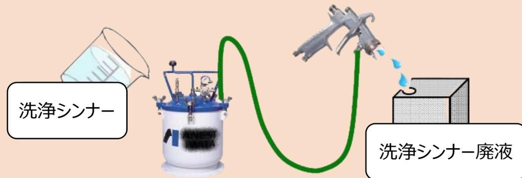
塗料吹き付けで使用するタンク、ホース、スプレーガンを洗浄シンナーで洗浄し、廃液は廃棄物処理
