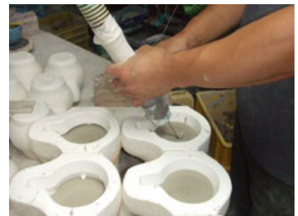
【ガバ鑄込み製法の流し込み工程】
