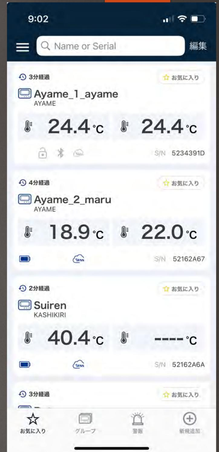
写真は全館休業時。データロガー1台につき2箇所の温度測定が可能（1箇所につき最大3m）なため、底と表層を計測している。
