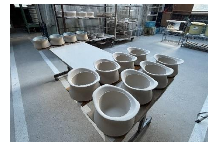
釉薬塗布前のポット 萬古焼のポットを内製化。商品価値を理解してもらうよう、釉薬塗り体験などを実施。 (出所：オープンファクトリーにて撮影)
