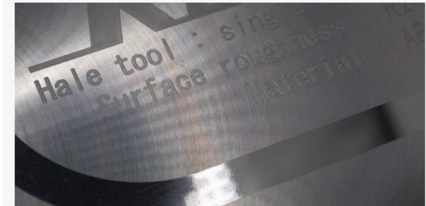
半導体部品の加工事例（ヘール加工） 機械により精密加工を行うことで、手作業による精度のバラツキを避けつつ高い機密性を実現する。 （出所:弘和テックHP( https://www.kouwa-tec.co.jp/semiconductor ))
