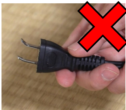
変形した電源プラグは使用しない
