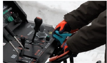
デッドマンクラッチ機構を洗濯 バサミで無効化する様子
