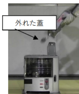
(写真) 消火後間もない高温の燃焼筒に灯油がかかり引火 (イメージ)
