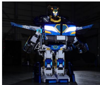
乗用人型変形ロボット「SR-01」 （外装パーツ：PP粉末材料 大型3 Dプリンタ製）
