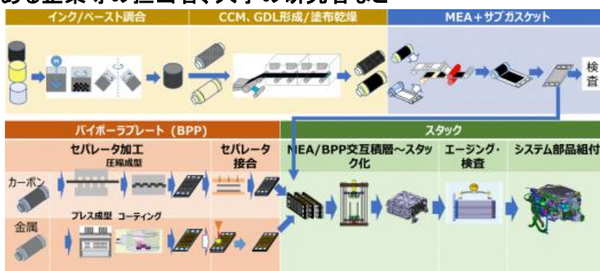
【図】燃料電池スタック生産工程
