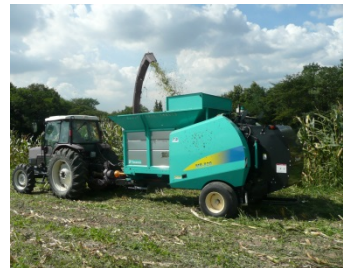
デントコーンを細断し、ロール状にしている作業風景。作業員1人での収穫が可能となり、大幅な作業の省力化、軽労化が実現
