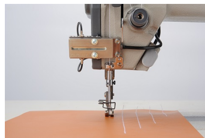
目飛び検出装置
