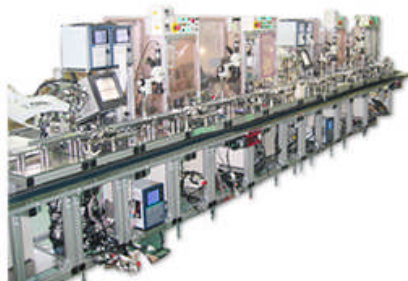
自動車関連設備 電子部品溶接ライン サーミスタ、抵抗部品の溶接検査をする装置です。
