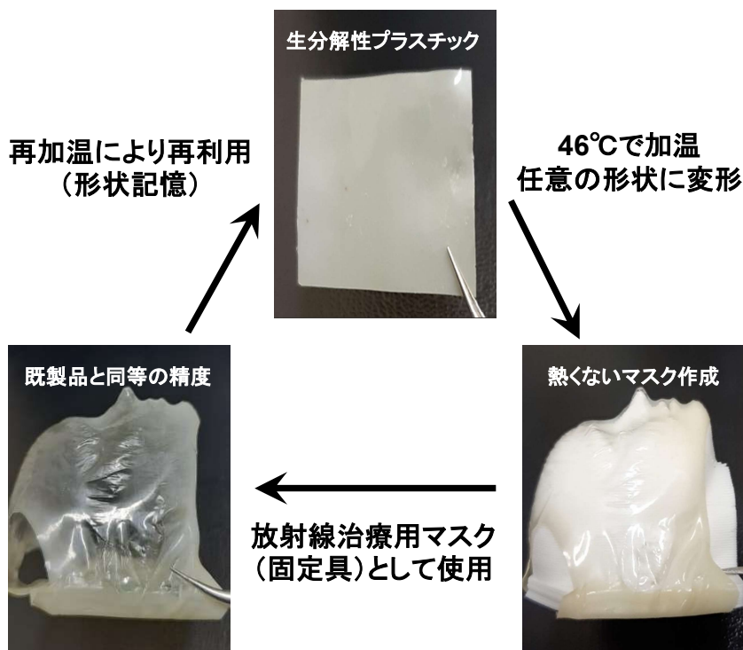
図 熱可塑性形状記憶ポリマーの放射線治療用マスクへの応用
