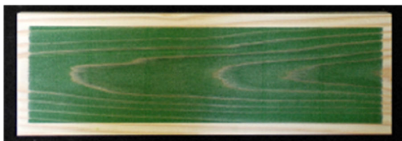
図 インサイジング加工及び樹脂含浸したスギ材 左上：インサイジング加工後の表面 右上：表面の拡大像 下：可視化のため樹脂含浸後の表面
