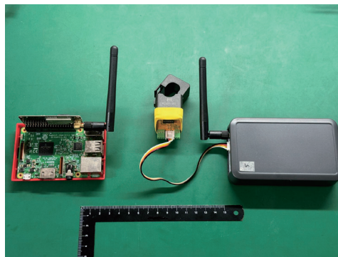
独自の信号横取り技術を活用した遠隔監視装置 「ATMICL-LoRa」
