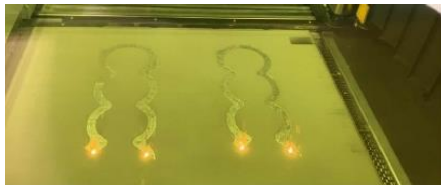
図.4気筒ウォータージャケットの造形状況
