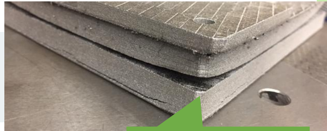
造形中の割れ
