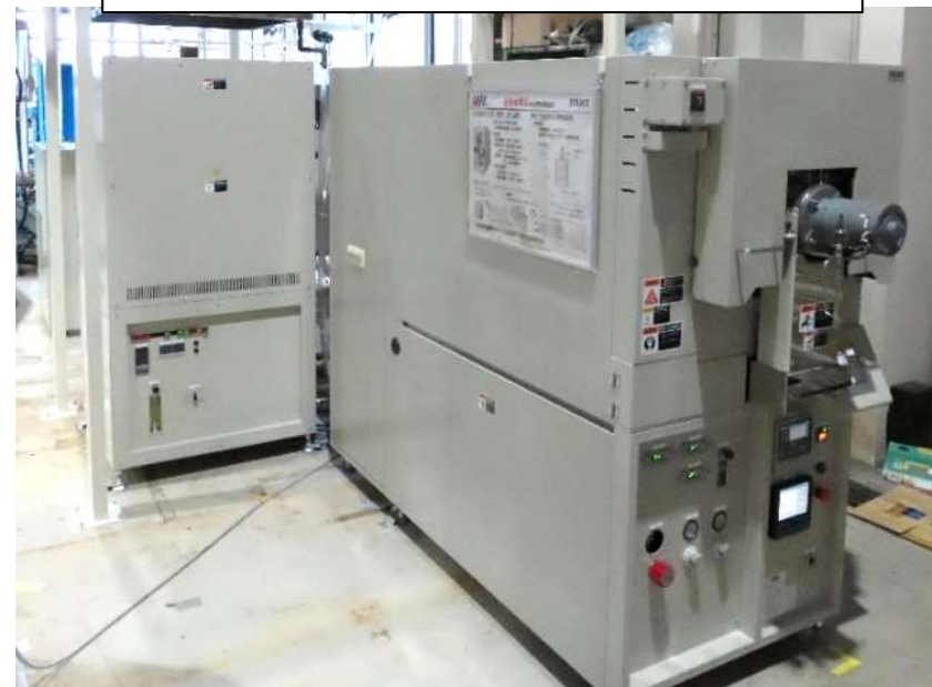
過熱水蒸気処理装置 2
