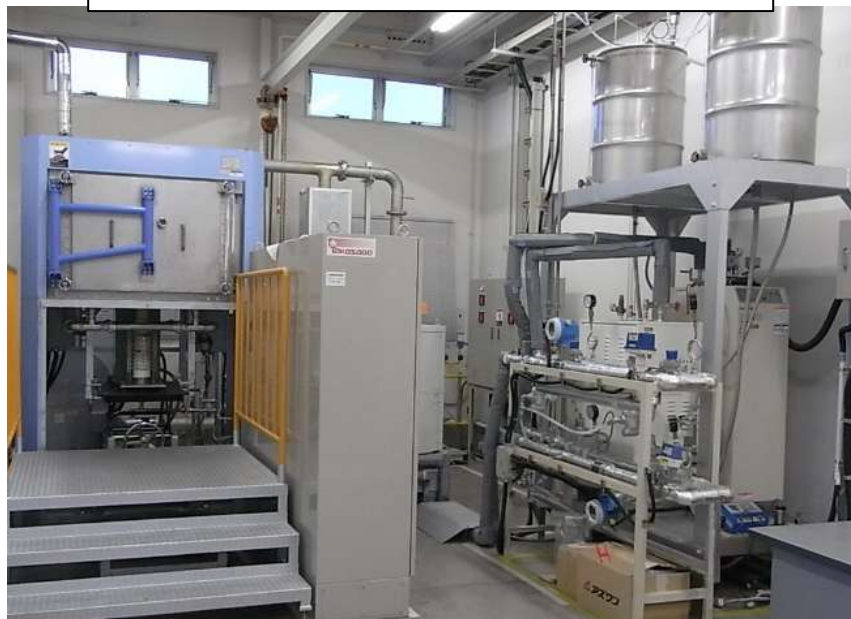
過熱水蒸気処理装置 1
