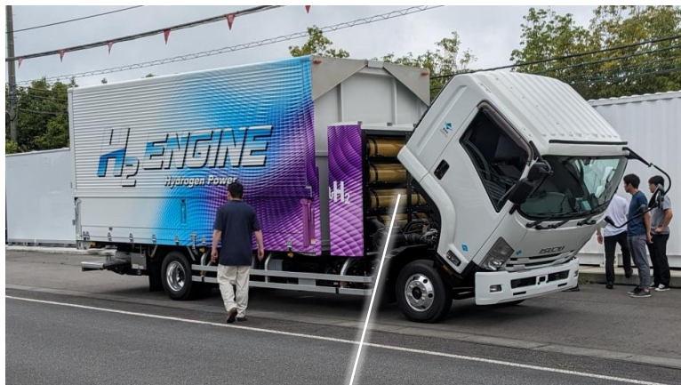
水素タンクモジュールは衝突安全性20Gに耐える構造
