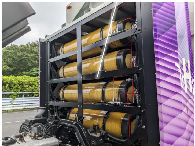
水素高圧タンクモジュール (トヨタ製 70Mpa、水素搭載量10kg)
