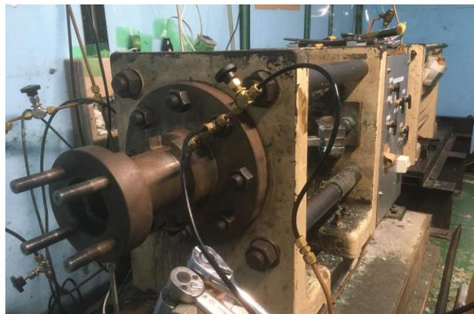
エンジン燃焼実験に用いる急速圧縮機
