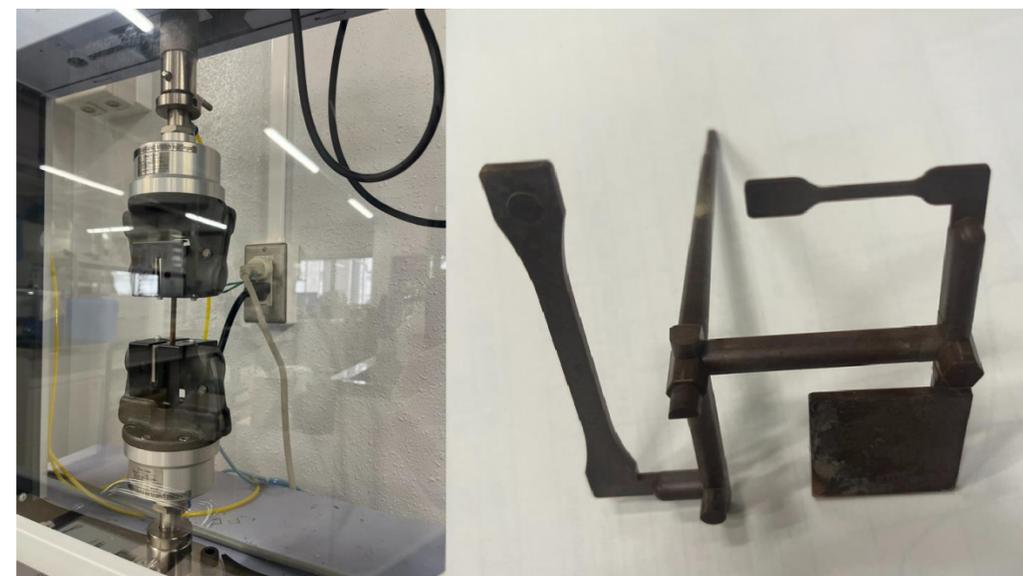
引張試験で竹50～70%と樹脂のサンプルを測定
