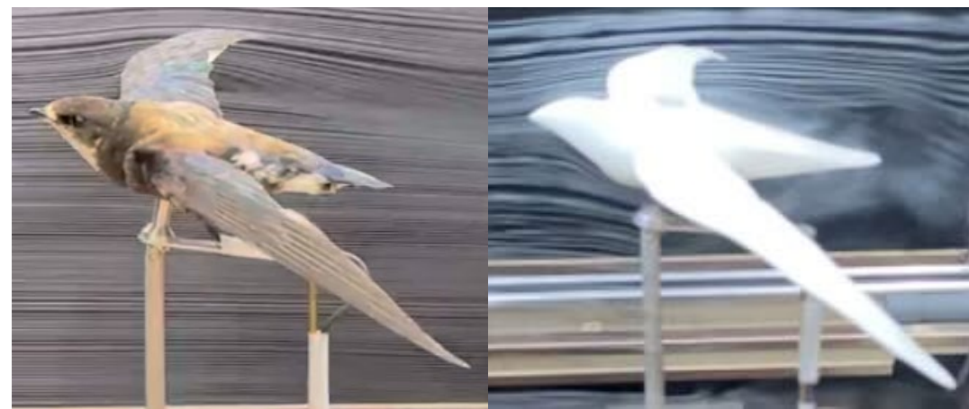
スモークワイヤ法による気流可視化(剥製 vs. 3DPrinter)
