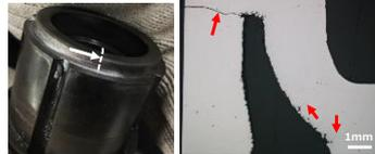
水路内壁でクラックが発生し、金型表面まで進展し、水漏れが発生
