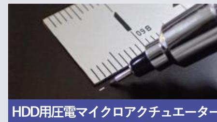
HDD用圧電マイクロアクチュエーター
