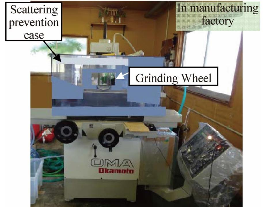
水加工機（平面研削試験機）<sup>2</sup>
