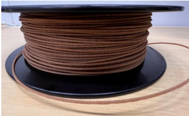
FGF 3Dプリンターで主として造形している材料
