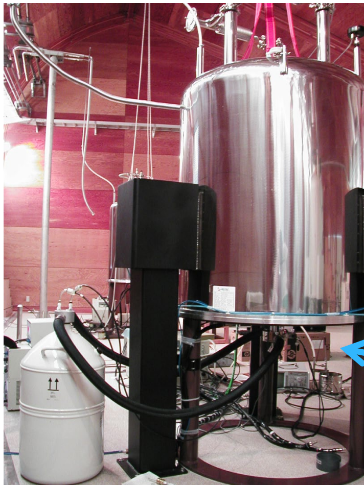
JEOL ECA-700と低温測定用液体窒素デュアー
