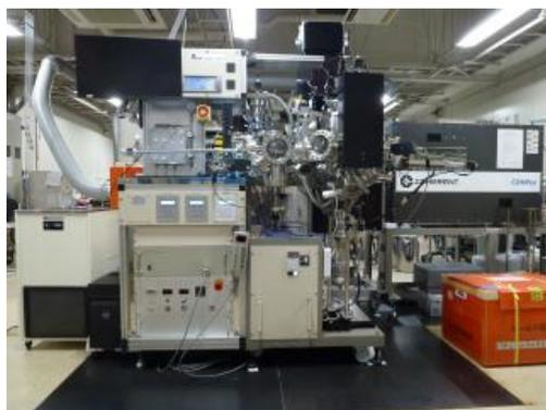
自動制御型パルスレーザ蒸着
