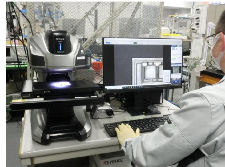
計測精度 (xy:0.5  $\mu$ m, z:0.4  $\mu$ m)
