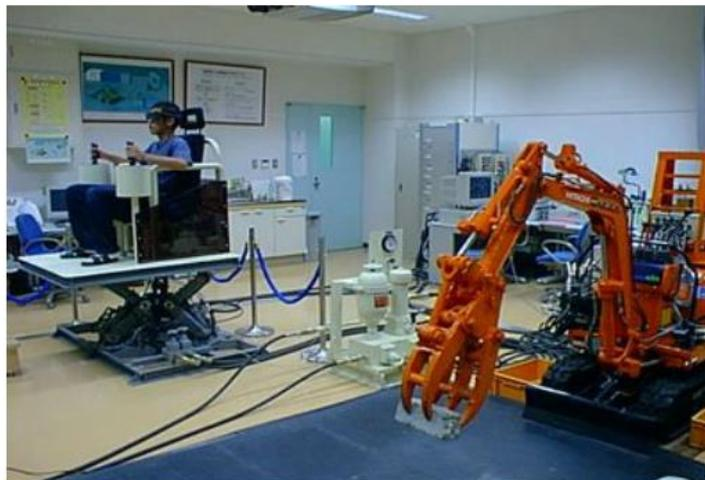
災害現場で役立つ遠隔操作臨場感提示建設ロボット
