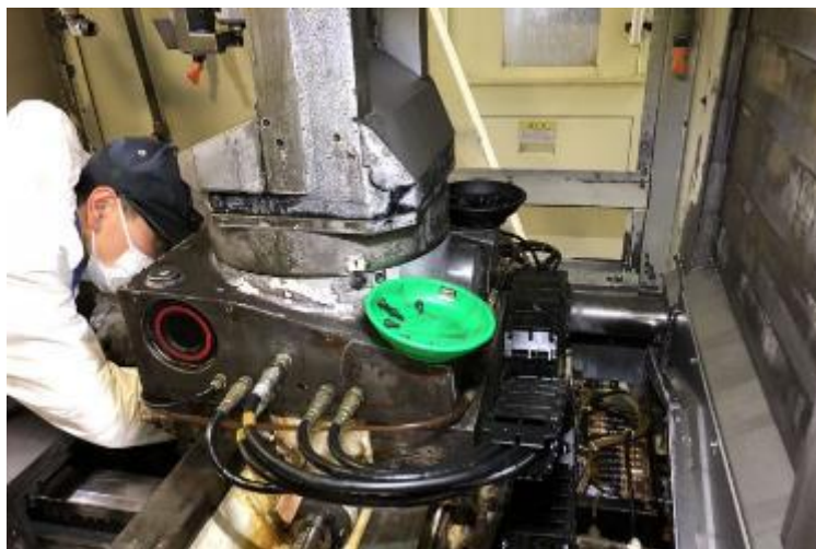
【定期保全：ユニット部品の 取り外し作業】
