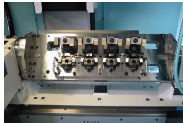
マシニングセンター用 4個取りインデックス治具
