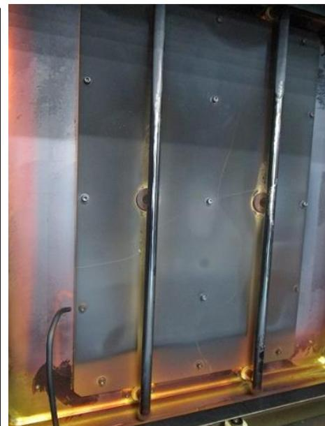
突き出し型600mmツインアンテナICPプラズマ源
