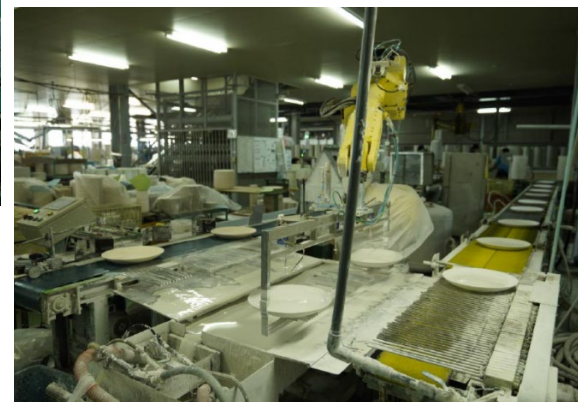
釉薬をつける工程は ロボットで自動化
