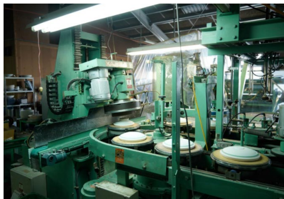
全自動成形機での 成形工程
