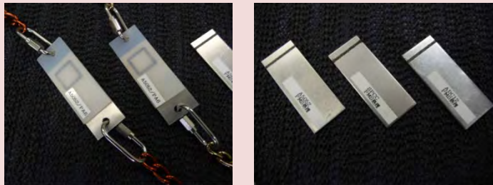
左：アルミニウムとプラスチックの接合後 右：PMS処理後のアルミニウム
