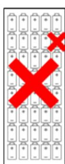
1個の電池セル故障で電池パック全体の動作停止
