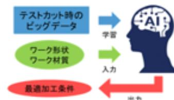
②新たな刃先温度・切削力の推定技術により、加工機が自律的に加工条件を補正しながら加工する。
