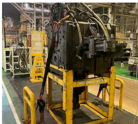
高重心金型は2点フックで固定（左）、低重心金型はエリアを定めて固定（右） することで被害を受けなかった
