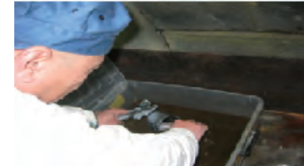
塗装用スプレー器具の洗浄作業
