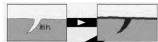
前処理 浸透処理 浸透探傷試験 (イメージ)
