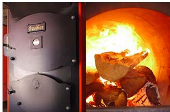
バイオマスボイラー
