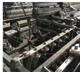
【糸の張力を均等に保つ(多段式糸送り機構の導入)ことにより編地の柄・模様によじれ・歪みを解消】
