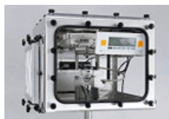
【ダストディパーチャー \alpha 】 粉塵供給、粉塵環境試験装置
