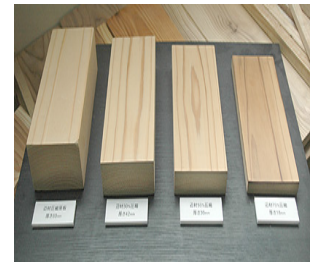
【杉材の圧縮サンプル(左から原板、30%圧縮、50%圧縮、70%圧縮)】
