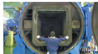
国内最大級の超大型真空熱処理炉
